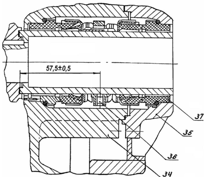
34 – корпус уплотнения; 35 – крышка уплотнения; 36 – винт; 37 – уплотнение торцовое
